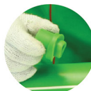
รูปการขุ่นขึ้นเป็นชั้นของข้อต่ออานม้าที่เกิดจากการให้ความร้อน
