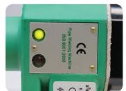
ไฟเขียว แสดงถึงสามารถใช้งานได้แล้ว
